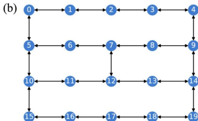
**Diagrama:** a) PQRNG e b) arquitetura do computador IBM 20Q
